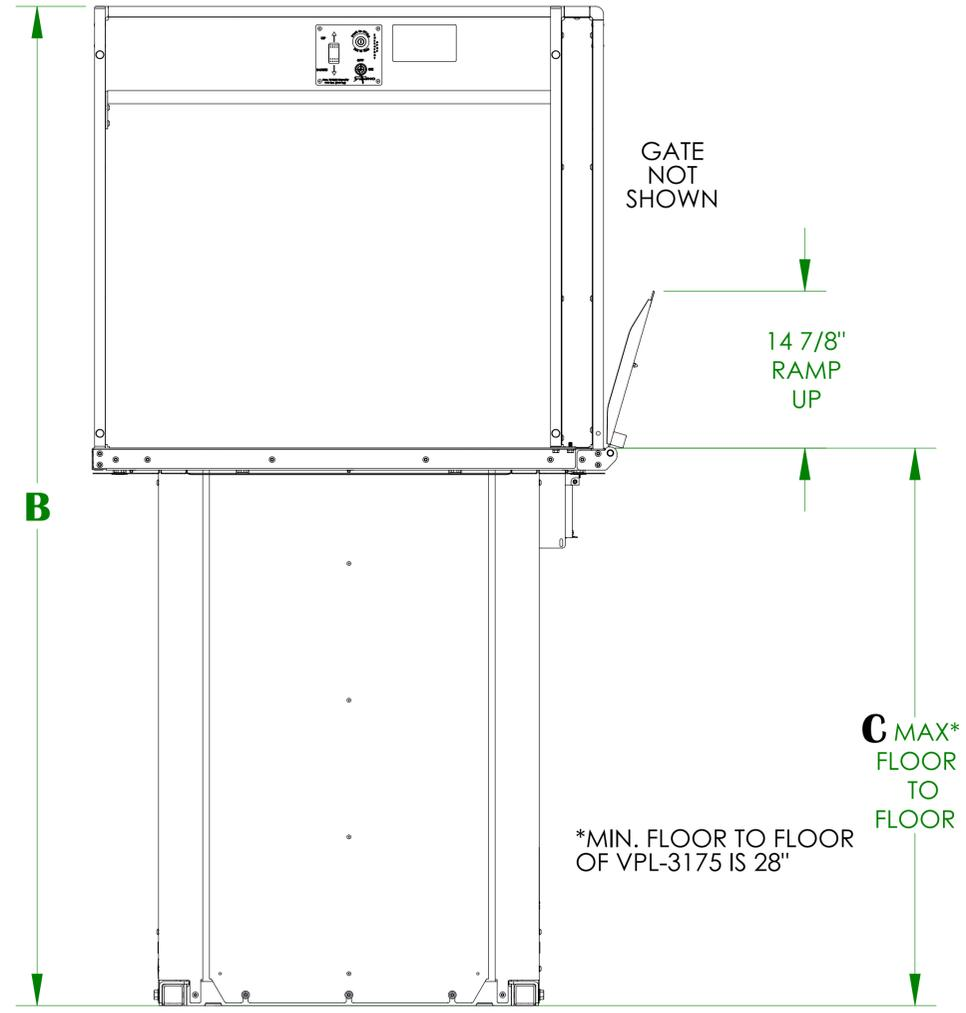
NOTES: 1) ACCESS RAMP & PLATFORM GATE CAN BE MOUNTED ON EITHER SIDE OF THE PLATFORM
